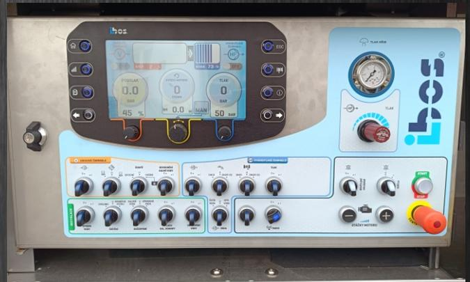
Man kann den Aufbau einfach mit der Hilfe von Steuerungspanel mit 9" Farbtuitivdisplay oder Radiofernbedienung AUTEK bedienen.
